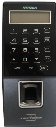
O terminal NAC corresponde ao dispositivo em si. Embora exista o software *Access Manager (ACM)* que permite realizar as configurações do terminal, de uma maneira mais prática, o terminal NAC já possui um sistema onde é possível realizar todas as configurações a partir dele próprio sem a necessidade do ACM.
